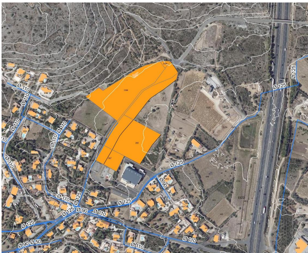
☞ Emplacement des réseaux AEP
